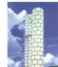
水膜除尘器 Water Membrane Dust Collector
